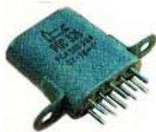
Электромагнитные реле типа РПС 32 являются слаботочными поляризованными двухпозиционными двухстабильными герметичными реле с двумя переключающими контактами и соответствуют ГОСТ 16121-86, ГОСТ ВД 16121-86 и техническим условиям ЯЛ0.452.080 ТУ.
