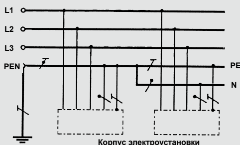
Рис.8: Система TN-C-S
