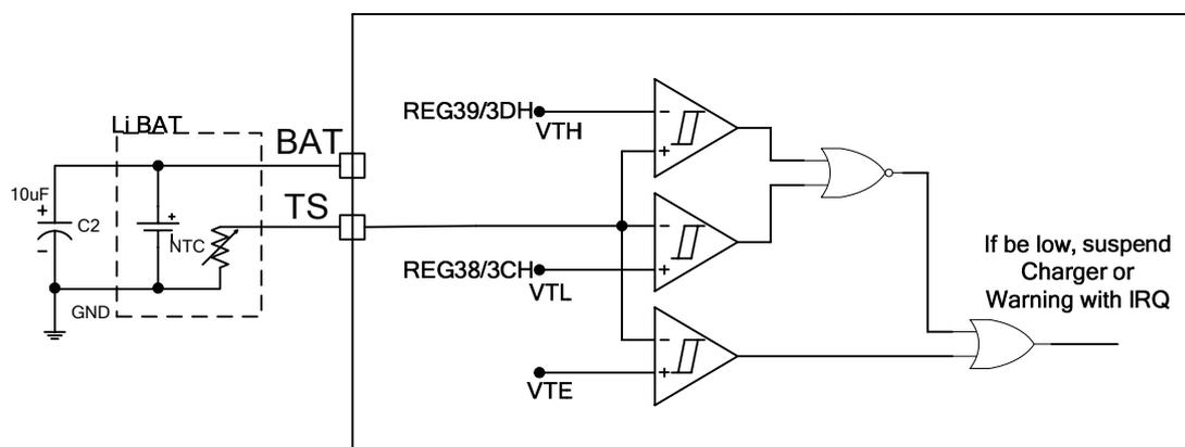
在上图中，VTH/VTL分别为高温和低温的门限设置，可分别通过寄存器REG38H/39H/3CH/3DH设置，VTE=0.2V。建议温敏电阻选用25℃时为10Kohm、精度1%的NTC温敏电阻。AXP173将在TS管脚上送出恒定电流，此电流可设置为20uA、40uA、60uA、80uA四种(参见寄存器REG84H)，以适应不同的NTC电阻。此电流流过温敏电阻，得到一个检测电压，AXP173通过ADC测出电压值并与设置值进行比较，从而发出相应的IRQ或是暂停充电。
